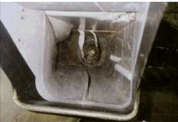
Beschädigung an einem Tornado infolge eines Vogelschlages
